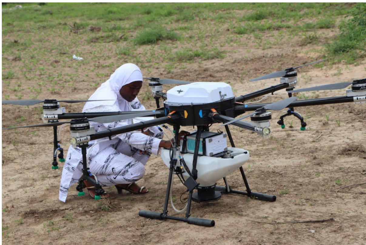
Image 1 : Réglage d'un drone pour relargage contrôlé des herbicides dans le littoral
